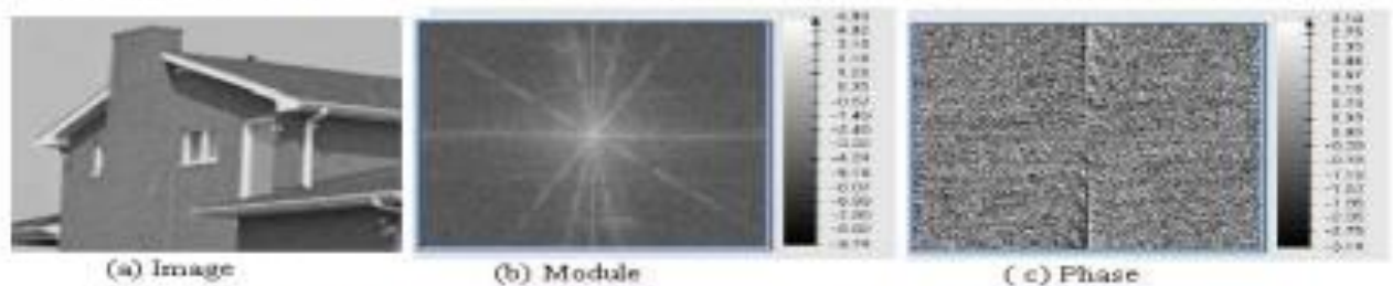
Figure 4.16. Spectre d'amplitude et de phase d'une image
