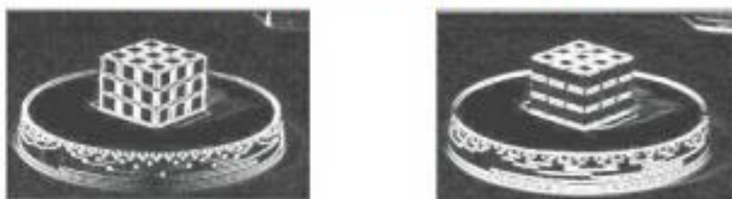
Figure.5.12. Gradient de Deriche suivant x (gauche) et suivant y (droite)
