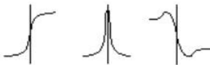
Figure 5.2. Fonction d'intensité au voisinage d'un contour en marche et ses dérivées première et seconde.
