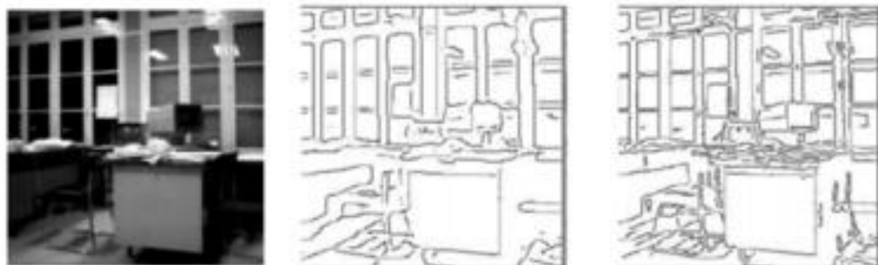
Figure 5.13. Seuillages des extrema locaux pour différentes valeurs du paramètre du filtre de Deriche : (a) \alpha = 0.5 ., (b) \alpha = 1.5 .
