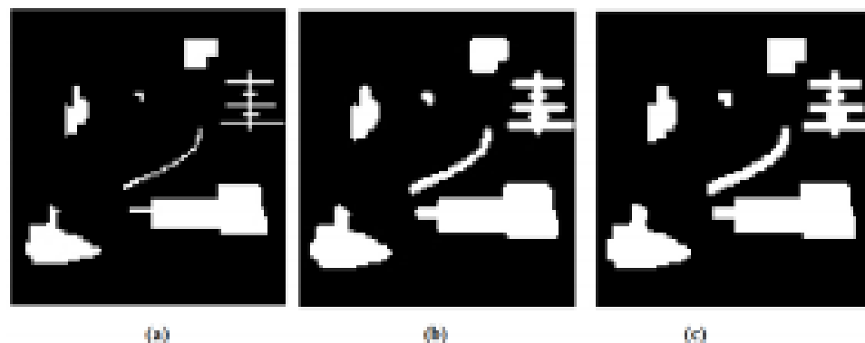
Figure 6.9. Image originale en (a), Images dilatées en 4-connexité (b) et en 8-connexité (c)
