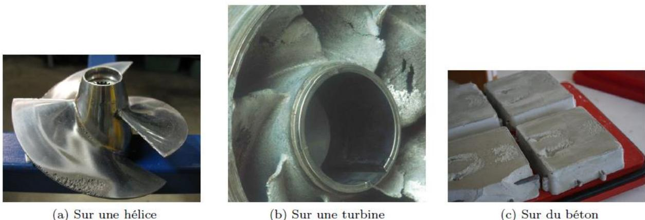
**Figure 1.3 :** *Effet de la cavitation sur différentes installations*
