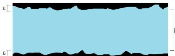
Figure IV.11 : Les aspérités de la surface intérieur d'une conduite
