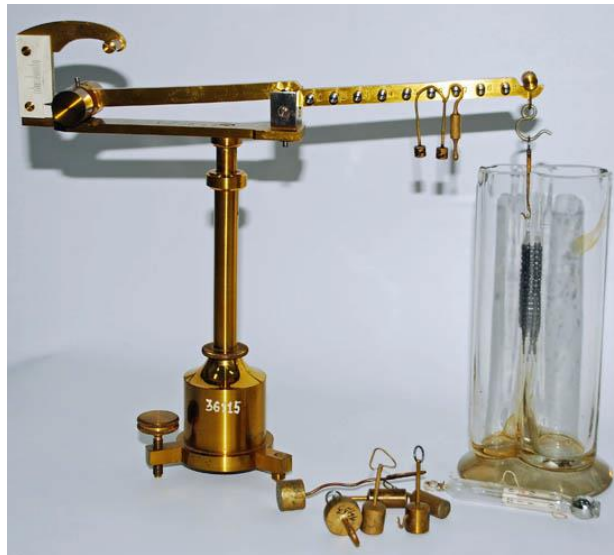
Figure.2 : Photo de la balance de Mohr-Westphal
