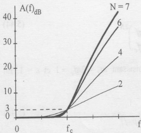
Fig. 5.17. L'atténuation en puissance en fonction de la fréquence pour différents ordres.
