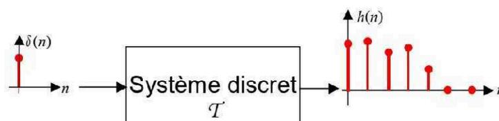
Figure.4. Réponse impulsionnelle d'un système
