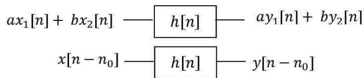
Un système peut être caractérisé par sa réponse impulsionnelle. Si on connaît la réponse impulsionnelle d'un système, alors on connaît sa sortie pour n'importe quelle entrée.
