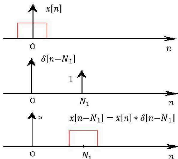
Figure.3. Utilisation de l'impulsion unité pour un décalage de  $N_1$  échantillons
