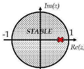
Figure.5. Pôle d'un système stable.
