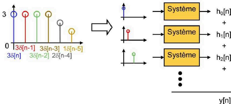
Figure.2. Sortie  $y[n]$  d'un système, constituée de la somme des réponses impulsionnelles correspondant aux entrées  $x[n]$
