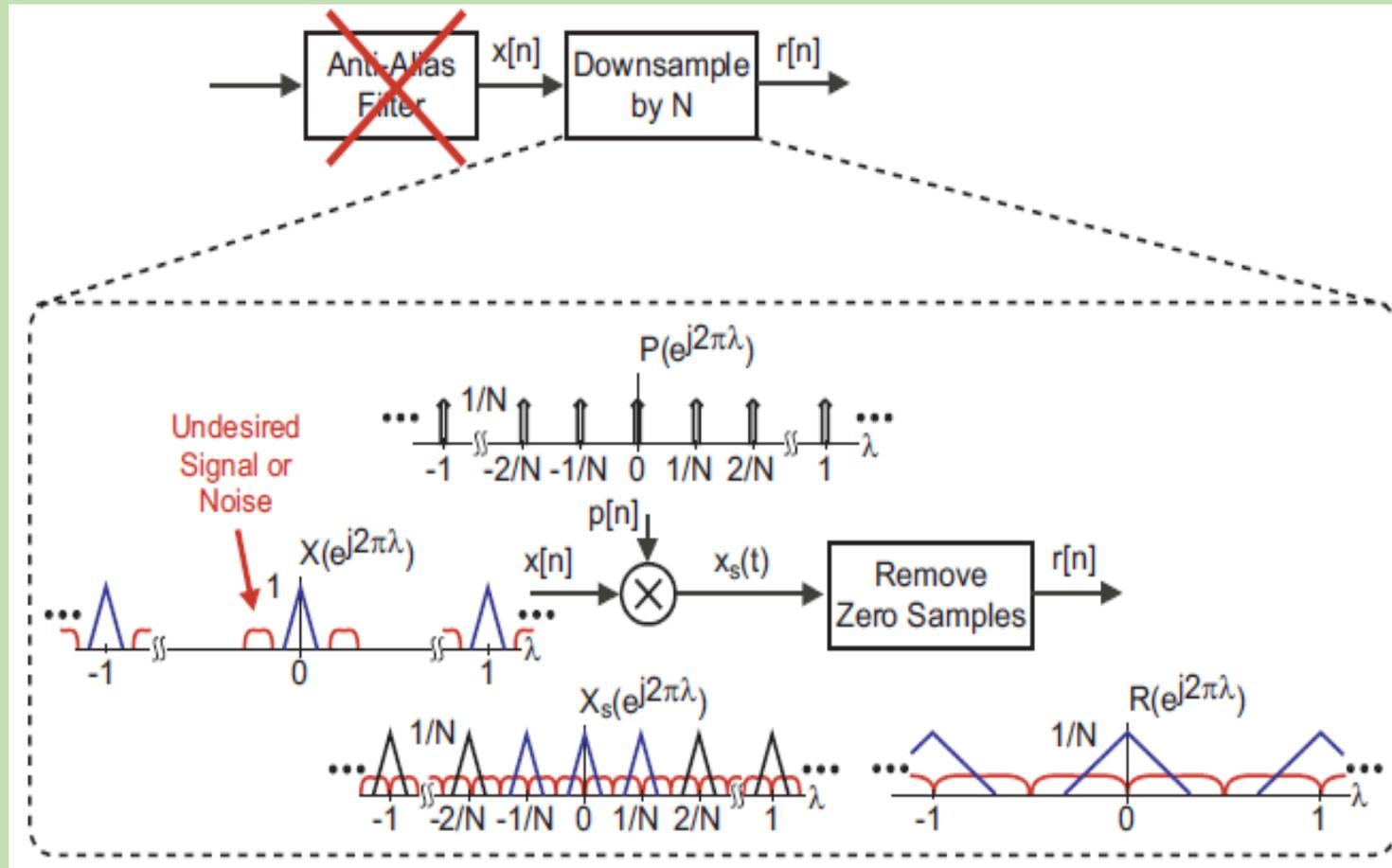
→ La suppression du filtre anti-repliement permettrait aux signaux non désirés ou au bruit d'intervenir dans la bande désirée du signal.
