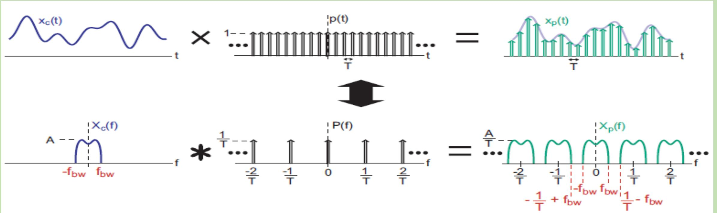
➔ Un chevauchement dans le domaine fréquentiel (c'est-à-dire un repliement) est évité si:
