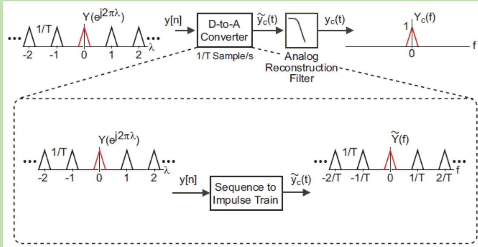
→ La conversion de la séquence au train d'impulsions est équivalente à un changement d'échelle de l'axe des fréquences par un taux d'échantillonnage égal à  $1/T$ .
