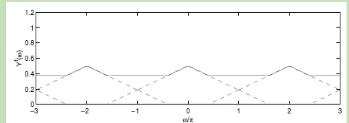
Lorsqu'un signal  $x(n)$  est sous-échantillonné, son spectre peut chevaucher avec les copies répétées (repliement). Lorsque le repliement se produit, le signal  $x(n)$  ne peut pas être récupéré après l'opération du sous-échantillonnage. Dans ce cas, l'information est perdue. Si le spectre de  $x(n)$  est nul pour  $\frac{\pi}{2} \leq |\omega| \leq \pi$ , il n'y aura pas de chevauchement, et on peut récupérer  $x(n)$ .
