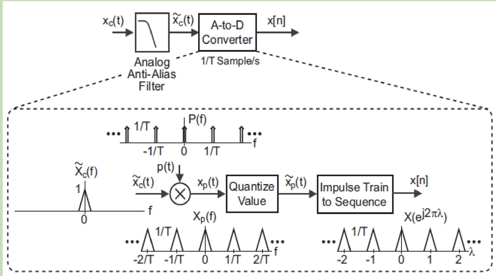
L'analyse du CAN est similaire à celle de l'échantillonneur.
