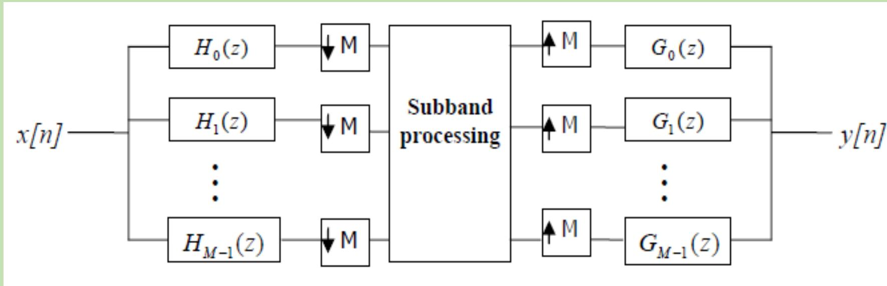
Structure standard d'un banc de filtres
