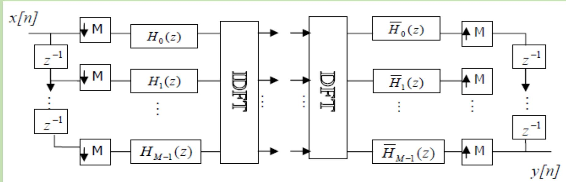
Structure d'un banc de filtres à DFT
