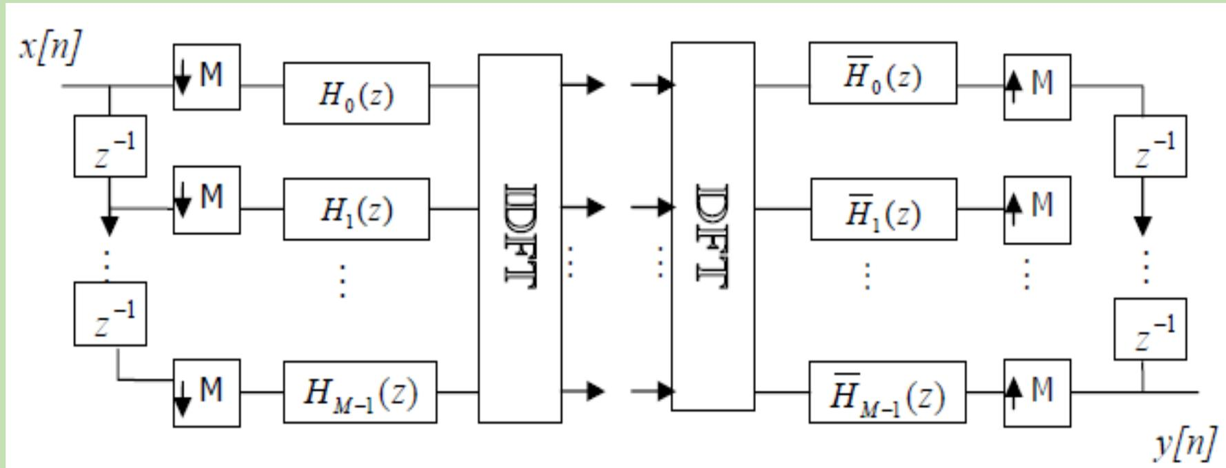
Structure d'un banc de filtres à DFT
