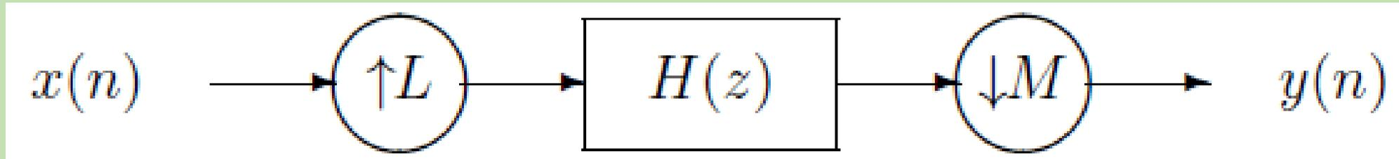
Le filtre est conçu pour éliminer à la fois les images spectrales et éviter le repliement. La cascade de deux filtres passe-bas idéaux est à nouveau un filtre passe-bas avec une fréquence de coupure qui est le minimum des deux fréquences de coupure. Donc, dans ce cas, la fréquence de coupure doit être
