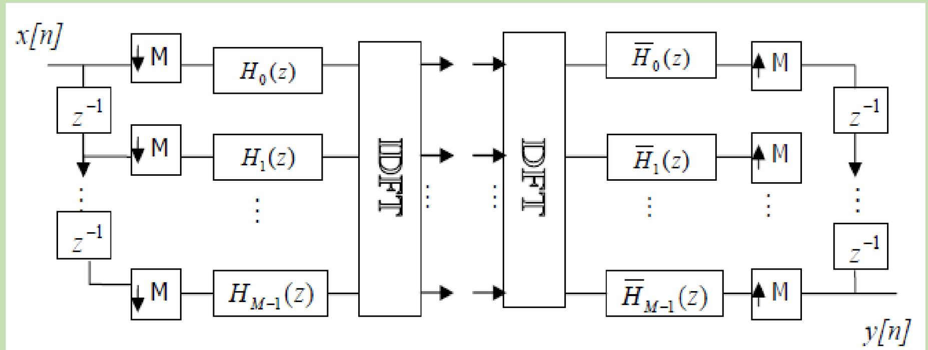
Structure d'un band de filtres à DFT
