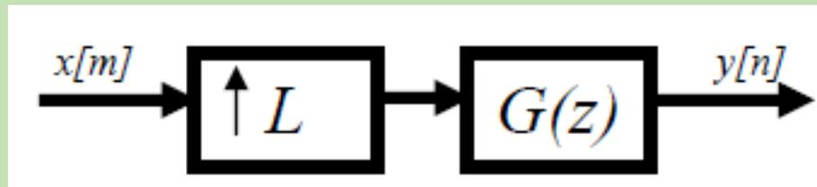
Interpolateur composé d'un sur-échantillonneur et d'un filtre anti-image
