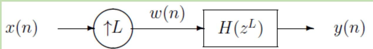
En utilisant la transformée Z, nous avons:  $W(z) = X(z^L)$  et  $Y(z) = H(z^L) W(z)$
