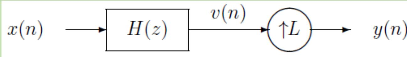
En utilisant la transformée en Z, nous avons:  $V(z) = H(z) X(z)$  et  $Y(z) = V(z^L)$
