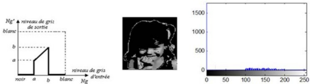
Figure 2.13. Seuillage avec fenêtre d'intensité entre 100 et 200
