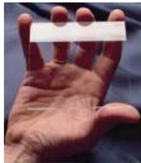
Verre de vitre avec un revêtement sol-gel poreux anti-réflexion en bas et sans revêtement en haut.
